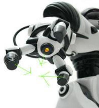
Wenn man bei der „Roboterpuppe“ die Finger zusammen gibt, bemerkt das der Sensor in der Hand von der „Roboterpuppe“ und überträgt es via Infrarot als „Befehl“ an die Motoren im großen Roboter, der somit dann die Bewegung 1:1 „nach macht“.
